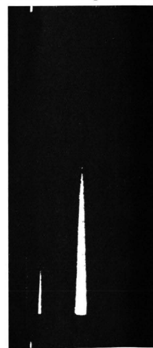
Abb. 5. Paarspektrum von \text{Na}^{24} . Das Bild ist gegenüber dem auf dem Oszillographenbildschirm entstehenden um 90^\circ verdreht.
